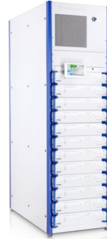
Trasmettitori raffr. liquido Potenze da 1.3 a 30kW Rendimenti tra il 46 ed il 50%
